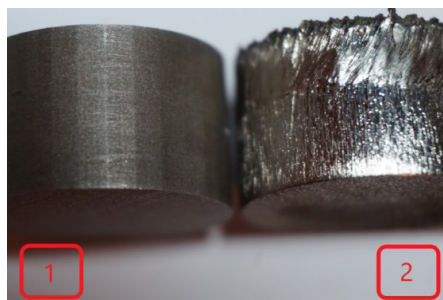
1 pav. Bandiniai išpjauti lazeriu ir WEDM staklėmis 1- Bandinys pjautas WEDM staklėmis; 2 – Bandinys pjautas lazeriu
